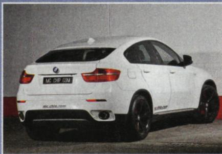
Auch wenn der X6 mit fast jedem Terrain zurechtkommt, ist er doch vor allem ein Asphalt-Fan. Daher montierten die mcchip-Mechaniker H&R-Tieferlegungsfedern und senken die Karosserie damit um gut 40/30 mm ab. Dazu gibt es schicke und in Schwarz lackierte BMW-Original-Leichtmetallfelgen in 20 Zoll.
