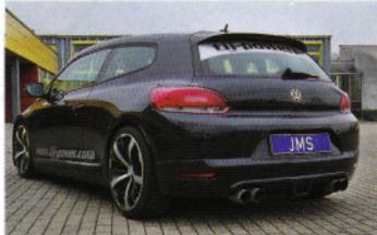
↑ディフューザーとマフラーのコンビネーションも完璧。ラウンド4パイプを備えたエクゾーストシステムは日本のチューニングファンにも馴染みのeisenmann製。リアルカーボンを使用したインサートがスポーティイメージを盛り上げてくれる
